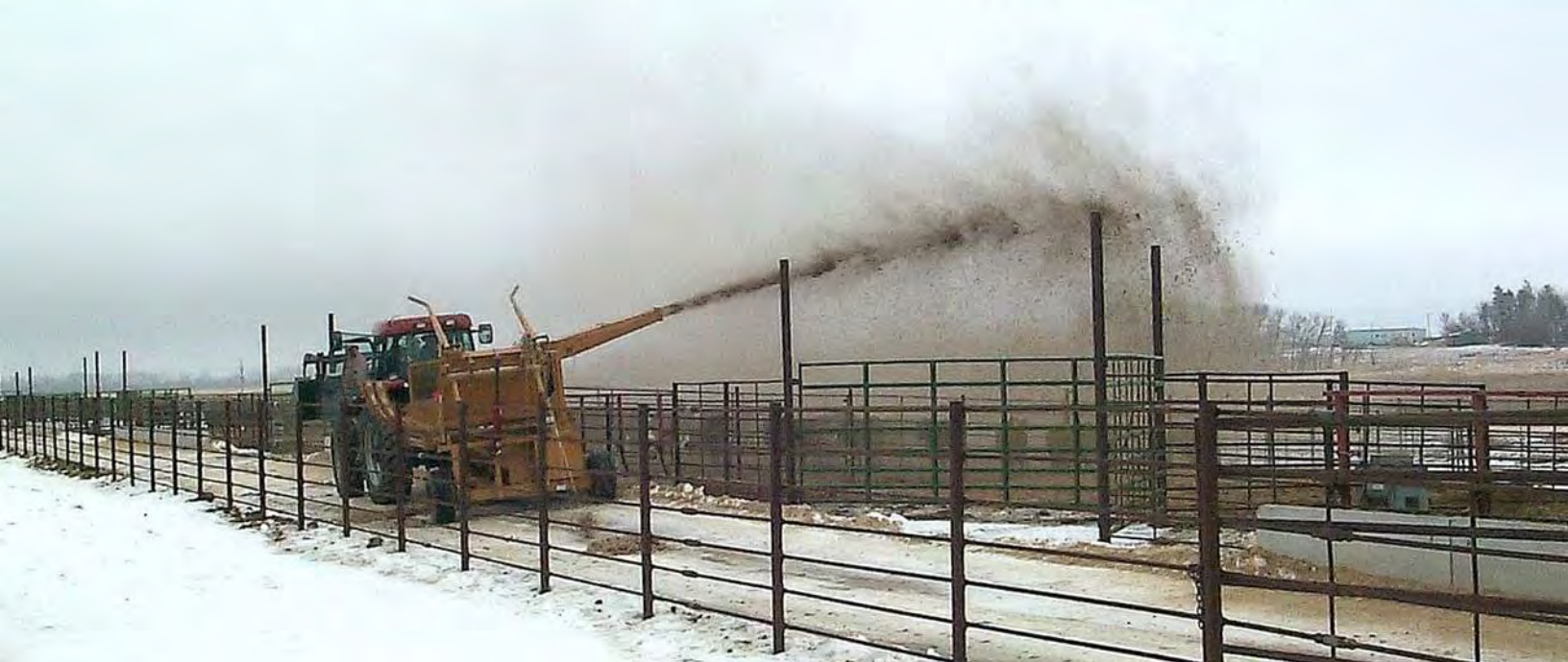
"Пушка для сена" обеспечивает подстилку для скота. (Фото любезно предоставлено Haybuster Inc.)
