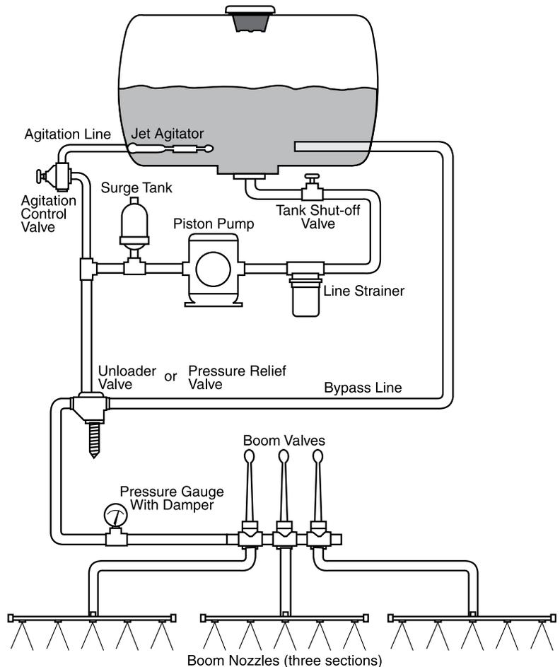
**Figure 7. Unloader valve.**
